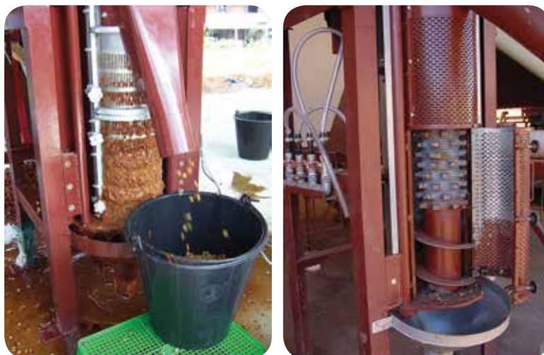
Hình 15. Đánh nhót cơ học và cấu tạo bên trong máy đánh nhót trục đứng
