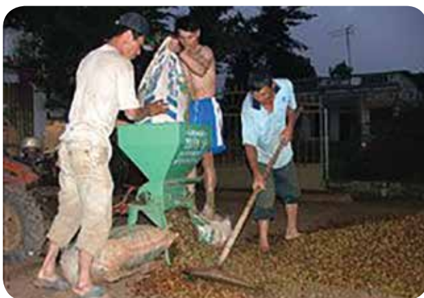
Hình 10. Xát dập cà phê trước khi phơi
