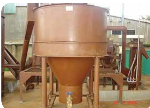
Hình 3. Bể siphon kim loại
