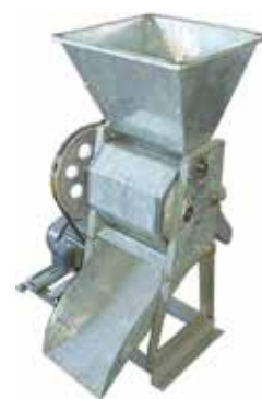
Hình 9. Máy xát trống ngang
