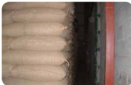
Hình 3. Cà phê xếp theo lớp, cách tường \geq 20\text{cm}
